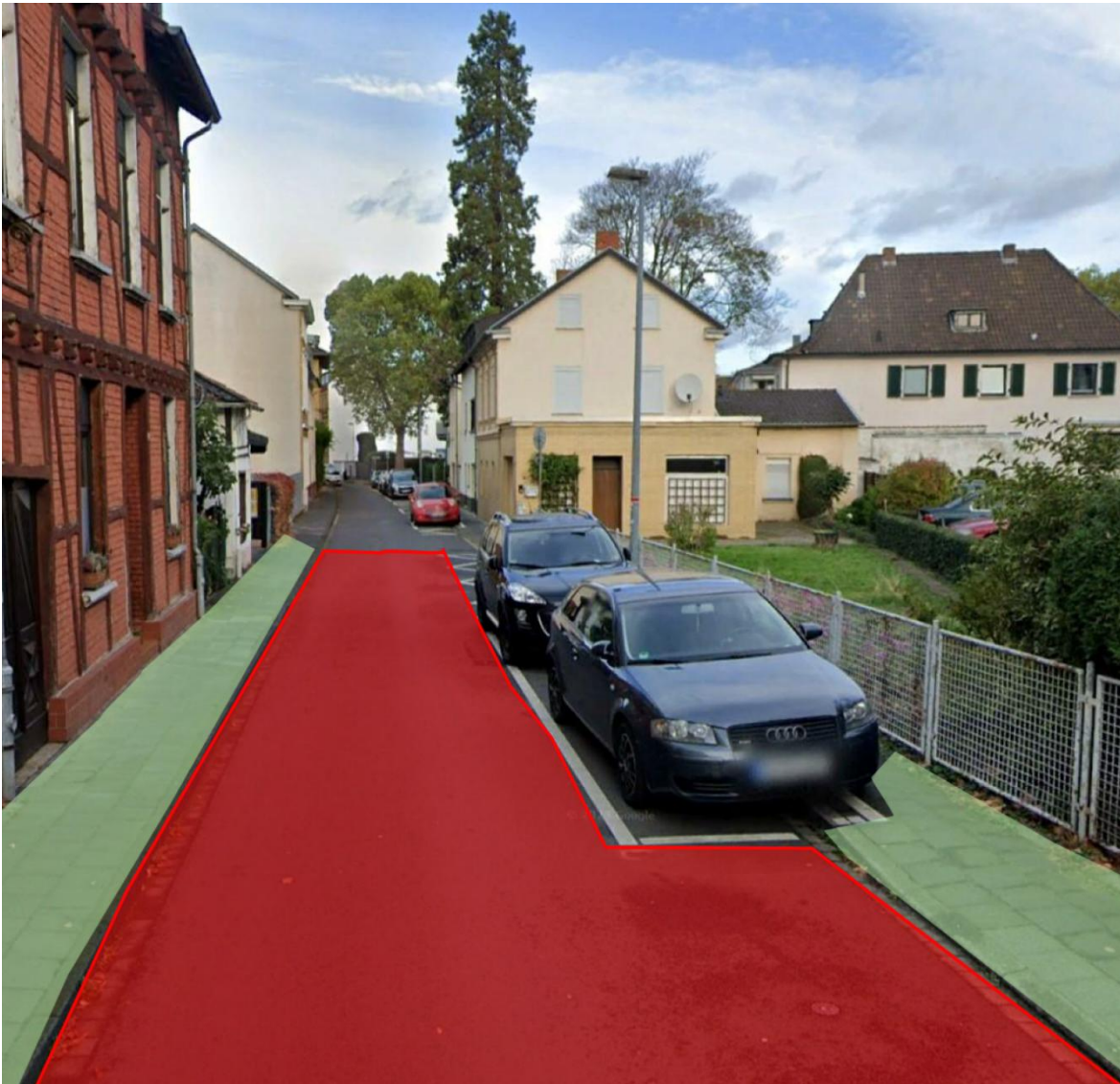
Abbildung 64: stark eingeschränkte Gehwegbreite durch aufgesetztes Parken in der Grabenstraße (grün: Gehwegfläche, rot: Fahrbahnfläche)
