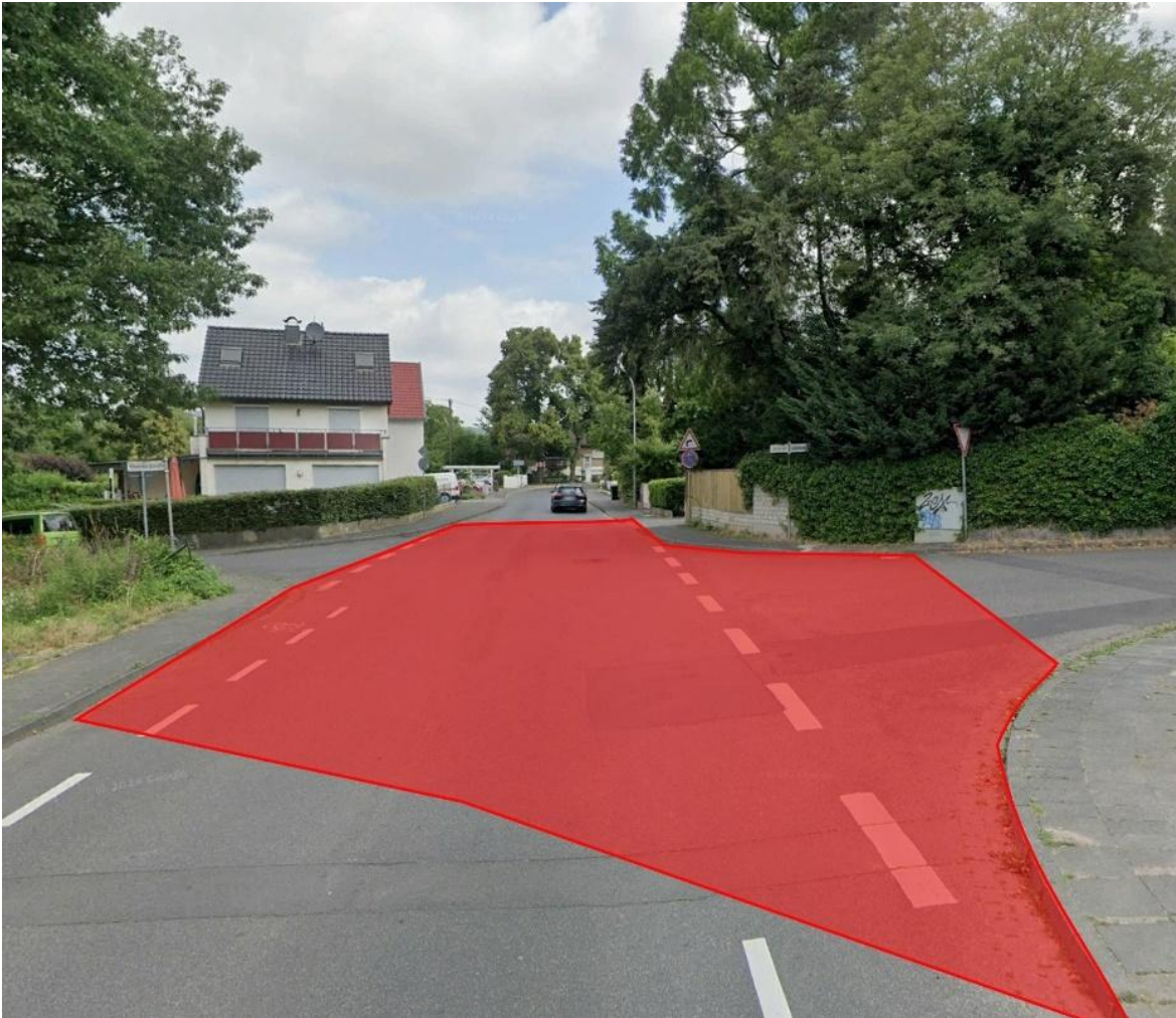
Abbildung 84: fehlende Querungsstelle im Kreuzungsbereich Bergstraße / Petersbergstraße (rote Markierung: Fahrbahnfläche)
